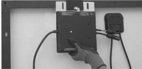
4. Con la llave de vaso de 13 mm o 1/2 pulgada, apriete el tornillo de cabeza hasta alcanzar un par de apriete de 18 Nm (13 libras/pie).
